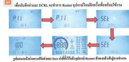
รูปแสดงหน้าจอการปรับค่าและ Save ค่าที่ตั้งไว้แล้วอุปกรณ์ Restart ด้วยตนเองเข้าทำงาน
